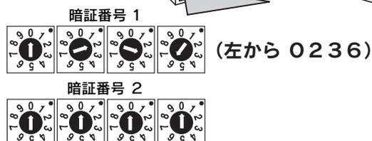
建物エントランスのオートロックは、キーなどを使用して解錠する他に、集合玄関機に暗証番号を入力して開けることができます。暗証番号は4桁の数字で、盤内のロータリースイッチにより設定します。
